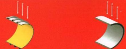
En utilisant le tube Pe ondulé renforcé, on économise jusqu'à 65 % du poids comparé à des tubes à parois lisses avec la même capacité statique.
